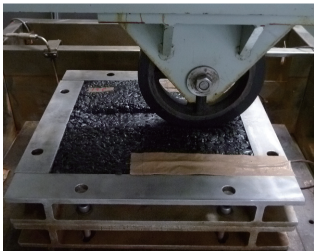
写真-8 ホイールトラッキング負荷試験状況
