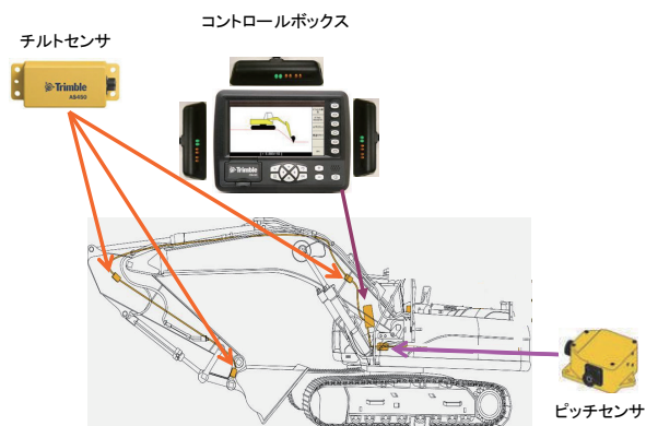
図-5 二次元 MG の機器構成
