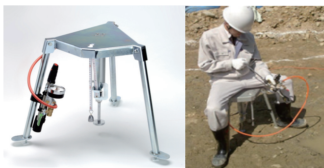
写真-1 小型簡易支持力試験機エレフット
