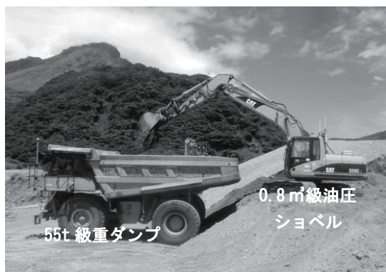
図-14 長崎県おしが谷掘削・積込み実験状況
