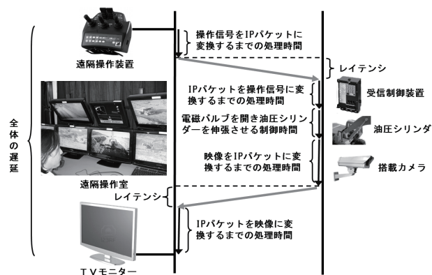
図-3 デジタル伝送による操作遅延と映像遅延
