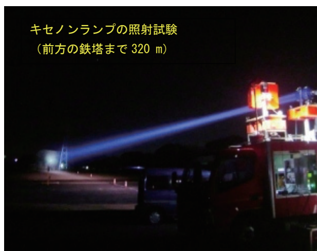
写真-1 キセノンランプの照射試験
