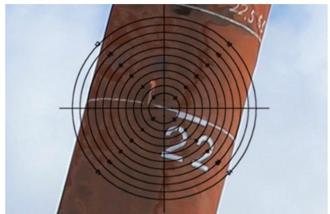
写真-6 Baum 内蔵 TS による斜杭計測
