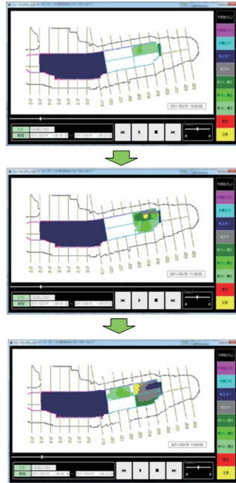
図-10 締固め時間管理再生画面例
