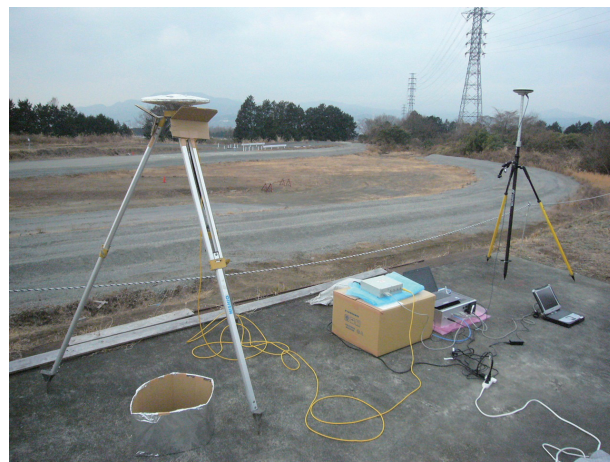
写真-2 基準点 T 9（左：LEX アンテナ、右：GNSS アンテナ）
