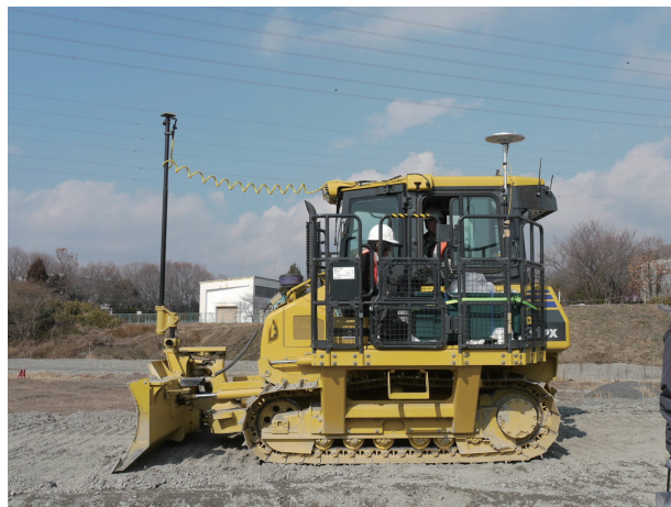
写真-3 LEX 受信機等を搭載したブルドーザ（左：排土板上：GNSS アンテナ、右：キャビン上：LEX アンテナ）
