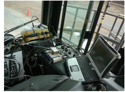
写真-6 制御データ変換システム(右側の PC)
