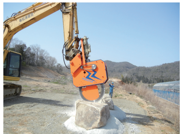
写真-5 バックホウに取り付けた開発中の試作機
