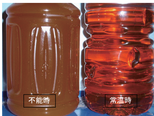
写真-7 機関始動不能時の燃料の状態
