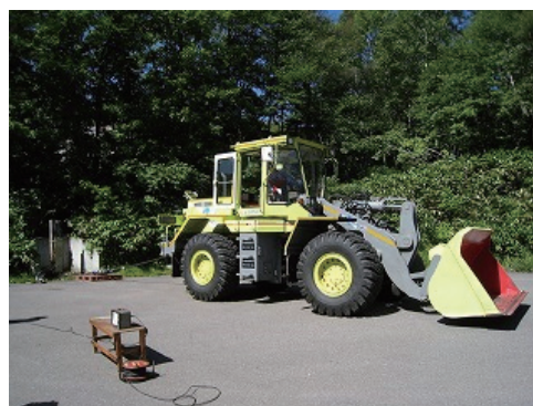
写真-3 牽引力試験
