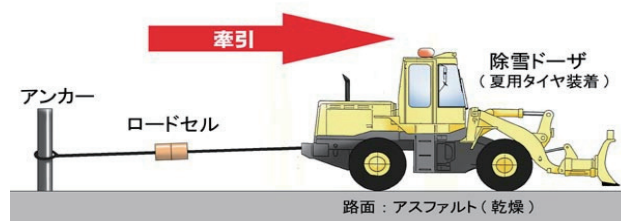
図-5 牽引力試験概要図
