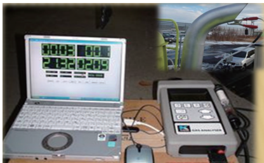
写真-4 排出ガス計測
