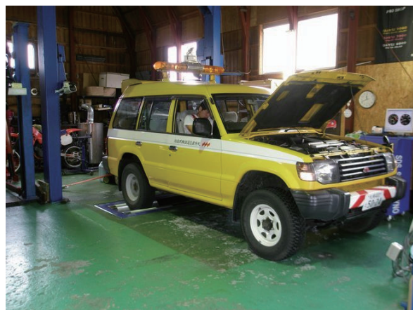
写真-2 出力・トルク計測
