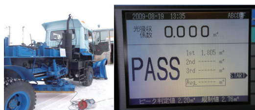
写真-5 粒子状物質（PM）測定試験
