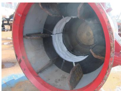
図-3 吸音材を配置したパイルスリーブ
