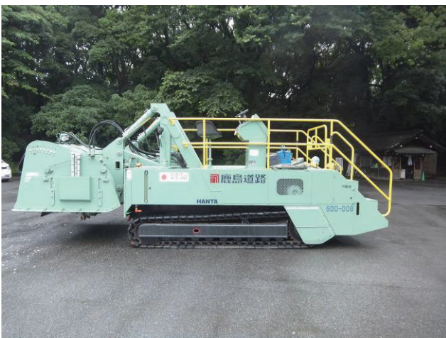
写真-2 ストーンセパレータ外観
