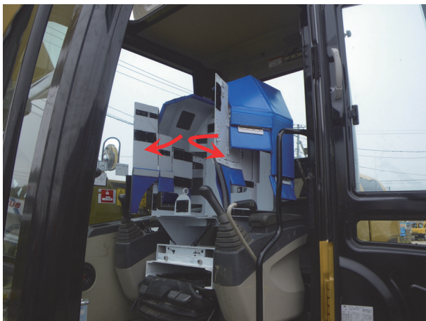
写真1 放射線シールドシート設置状況
