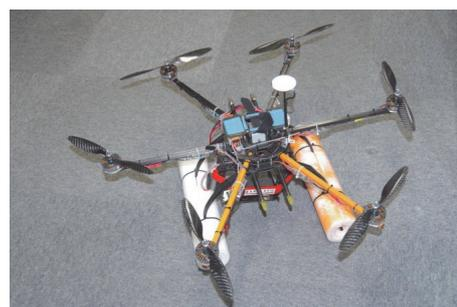
図-2 多軸回転翼型無人飛行体 (SARA-X)
