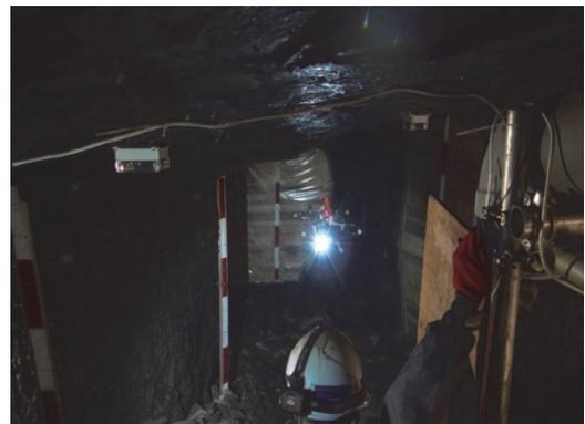
図-12 垂炭鉱内 (地下) で安定飛行した無人飛行体 (SARA-XUV)
