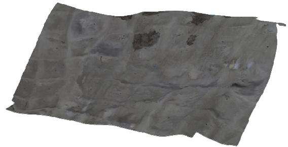
図-11 空撮した法面の 3 次元画像処理
