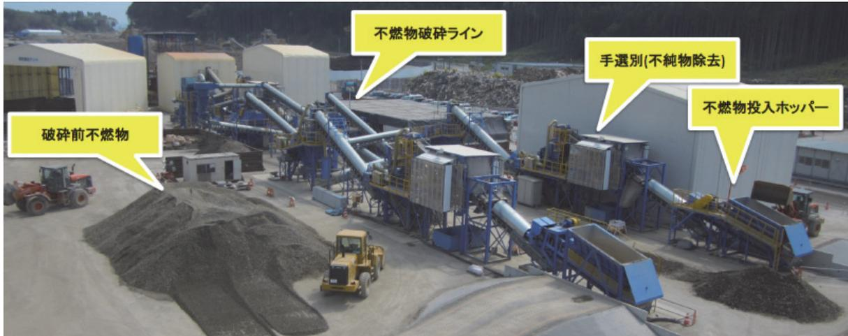
写真-5 造粒前処理施設（選別・破碎）
