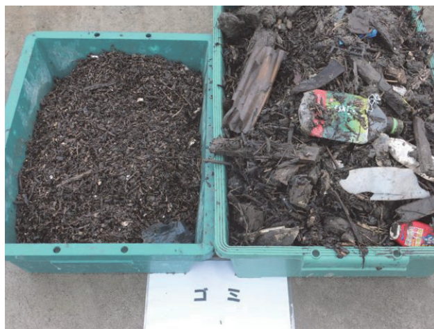
写真-4 水槽内で分離されたゴミ(右:加水時に浮上したゴミ, 左:攪拌過程で浮上した木片)
