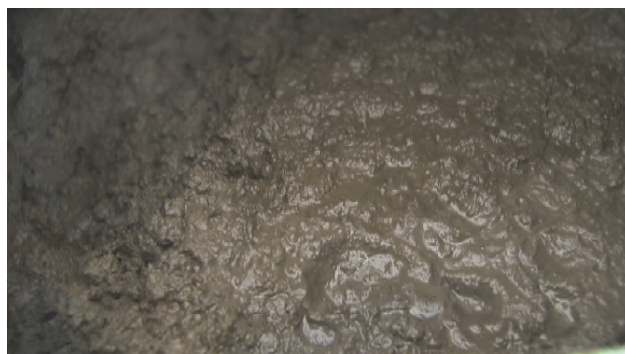
写真-7 スクリー式脱水機から排出されたブロック
