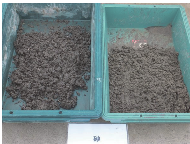
写真-6 分級された礫や砂(左:2段目スクリーンの礫, 右:1段目スクリーンの砂)
