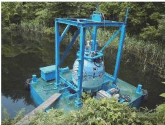
写真-1 台船上に搭載した底泥除去装置
