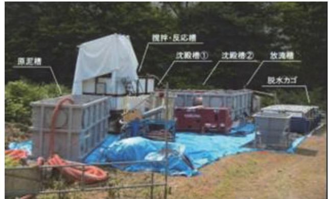
写真-2 固液分離・脱水プラント
