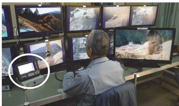
写真-5 ネットワーク伝送装置(CAN-LAN変換)
