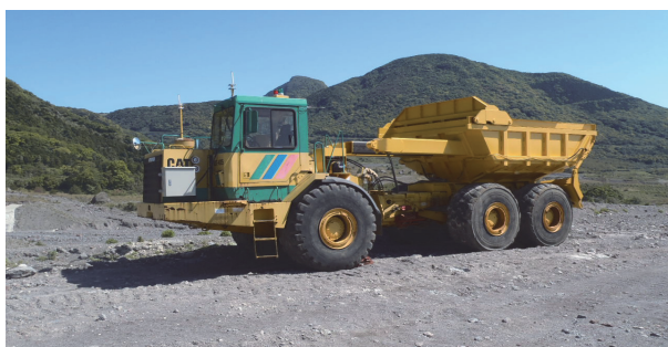
写真-7 40tアークユレトダンプトラック(エジクタータイプ)
