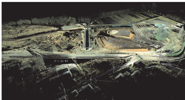
図-8 3D スキャナによる測量点群データ
