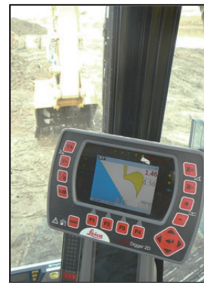
写真－1 運転席から見たモニタ画面 （バケットとモニタ視野）
