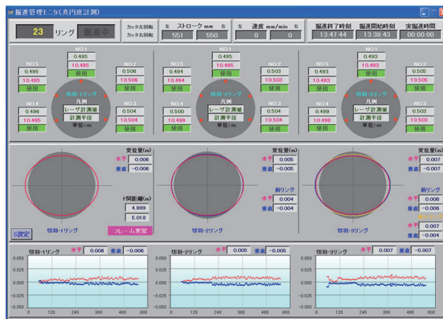
図-3 真円度計測表示画面
