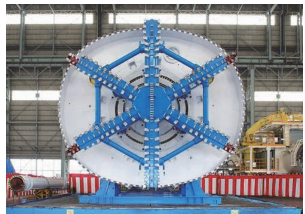
写真-1 通常のシールド機ベースの矩形マシン例
