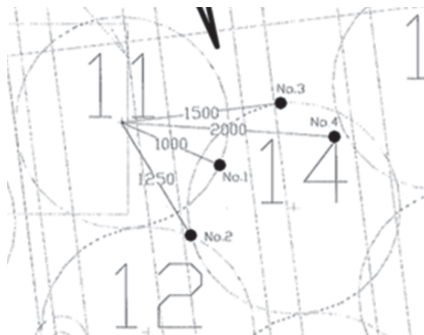
図-6 計測管設置平面図
