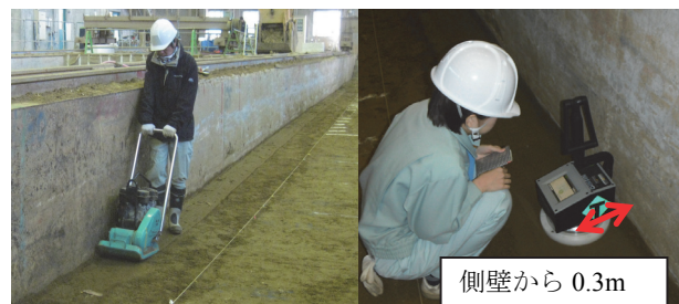
写真-4. 小型機械走行状況と密度測定状況
