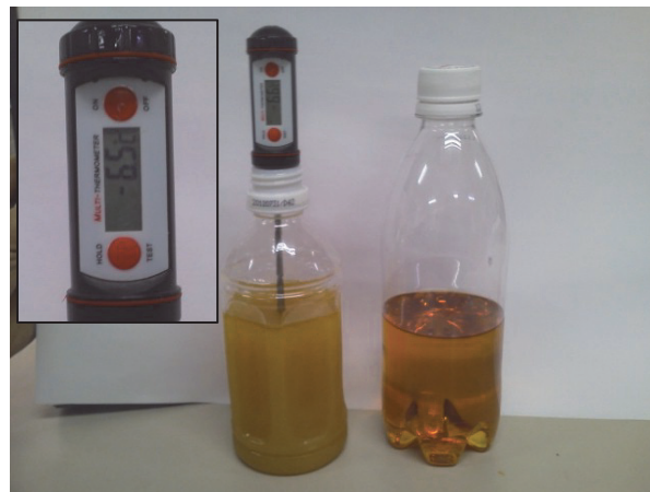
写真-5 低温度時の不純物析出状況
