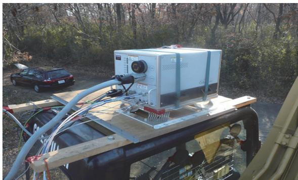
写真-2 車載型排出ガス計測装置設置状況
