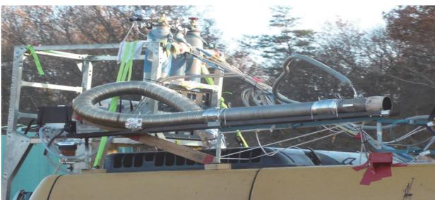
写真-3 排出ガス排気管アタッチメント設置状況
