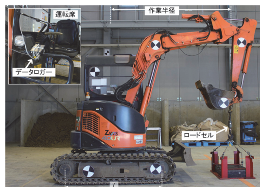
図-1 実験に使用した掘削用機械
