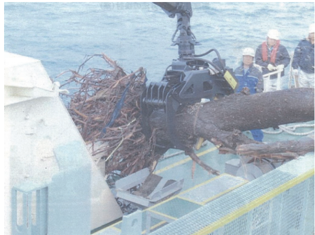
図-1 海面清掃船ゴミ回収作業状況
