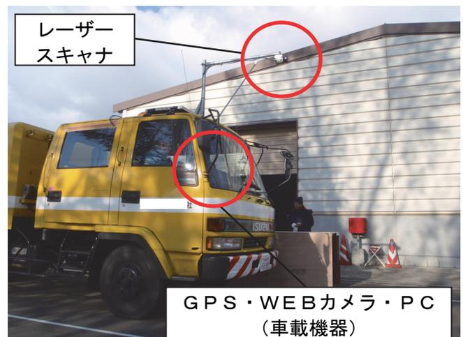
写真-3 試験状況 (夏期精度確認試験)
