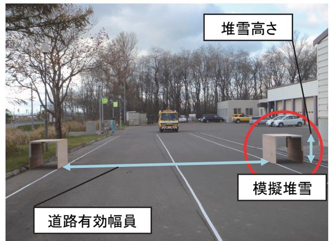
写真-2 模擬道路及び模擬堆雪 (夏期精度確認試験)
