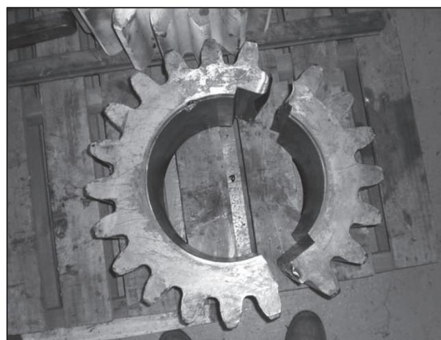
写真-3 ピニオンギヤ破損状況
