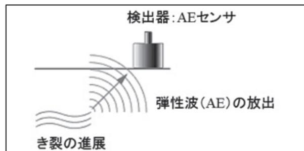
図-3 AE計測概念図
