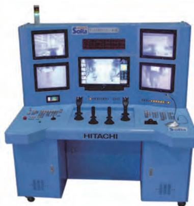
写真5. ASTACO SoRa 遠隔操作盤
