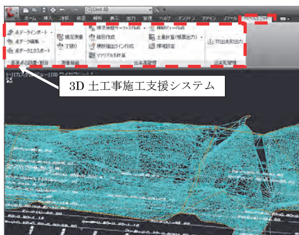
図-2 3D 施工支援システムの表示画面
