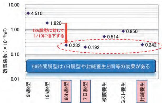
図-2 透気試験結果（模擬試験）
