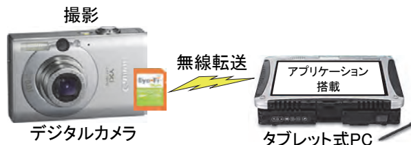
図-8 システムの機器構成
