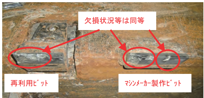
写真-5 掘進完了後のビット状況
