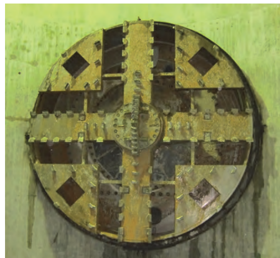
写真-6 シールドマシン面板(掘進後)
