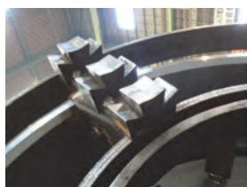
写真-5 ビット取付状況
