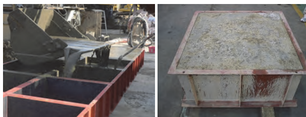
写真-3 供試体作製(左:流動化処理土打設、右:硬化養生後)
