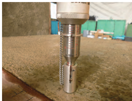
写真-4 針貫入試験による強度確認
