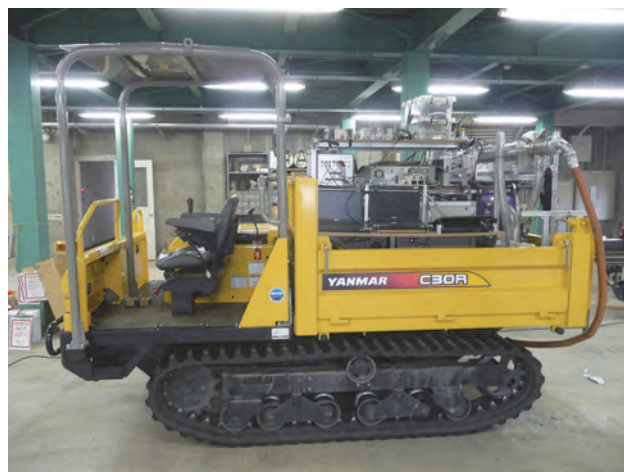
写真-1 計測装置の不整地運搬車への搭載状況
