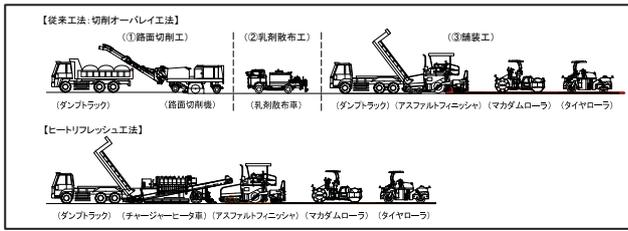
図-4 機械施工編成図比較
