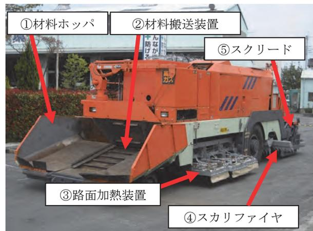
写真-7 新型専用施工機の全景
