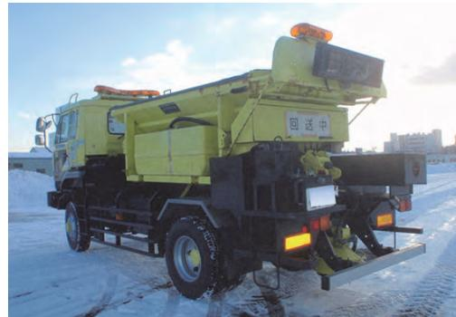
写真-7 試作した加熱水混合散布に対応した機械
