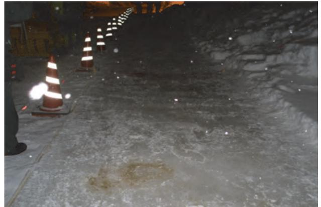
写真-7 作製した装置施工用雪氷路面(氷板)
