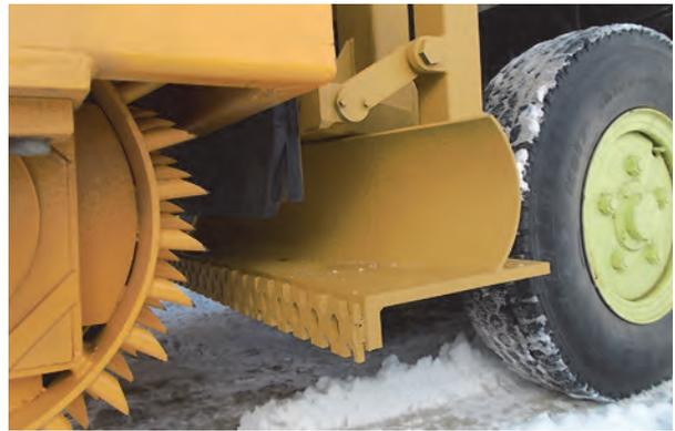
写真-4 雪氷路面処理装置の排雪部
