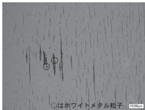
写真-6 N排水機場 分析フェログラフィ
