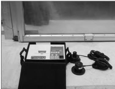
写真 平行光線透過率測定器
