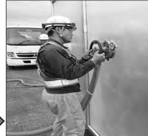
写真 WJによる下地処理実験
