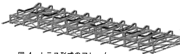
図-4 トラス形式のフレーム
