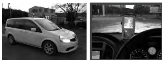
図-3 車両によるGNSS連続測量機材
