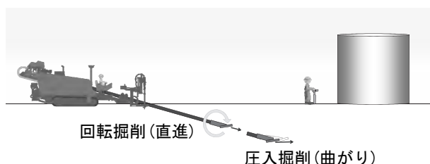
図-3 曲り削孔概要 1)
