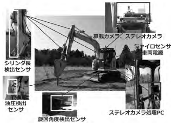
図-3 油圧ショベルへのセンサ搭載状況
