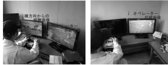
図-13 遠隔操作状況 (左: 2画面, 右: 1画面)
