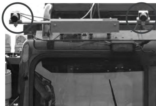
図-4 ステレオカメラ搭載状況
