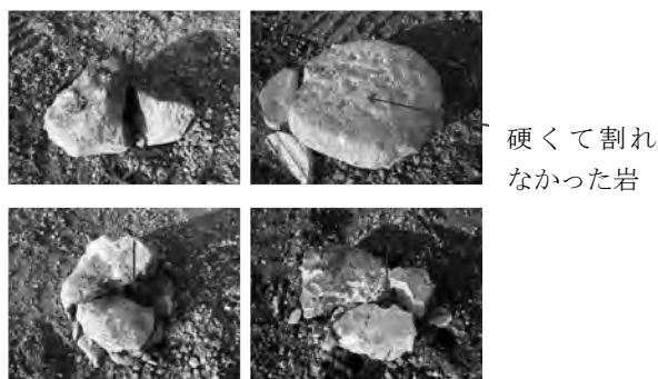
図-10 破碎した岩 (φ700~1000mm)
