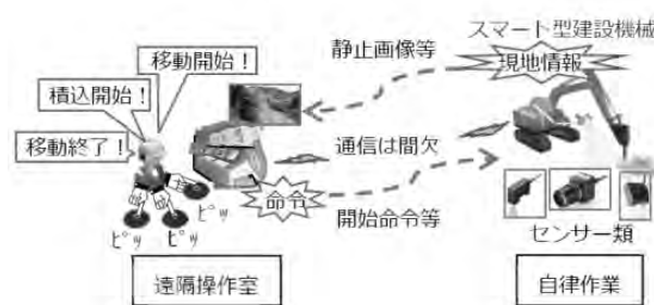
図-2 次世代無人化施工システム
