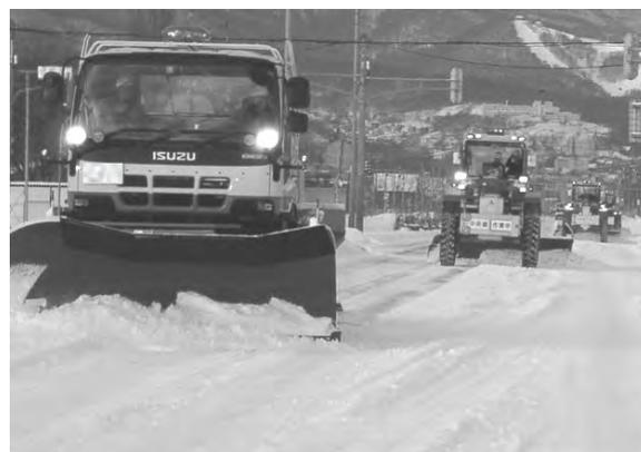
写真-1 雁行体制による除雪作業
