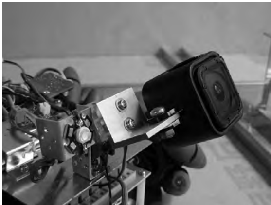
Fig.3 小型検査ロボットに搭載した Wi-Fi カメラ
