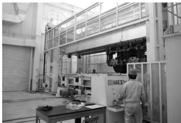
図-11 輪荷重載荷試験機
