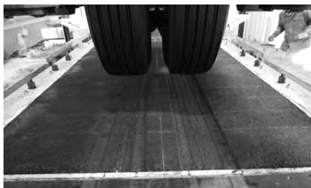
図-14 沈下状況(2.8万回載荷後)
