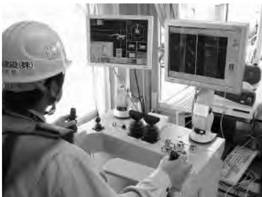
写真-20 体感式遠隔操縦システム
