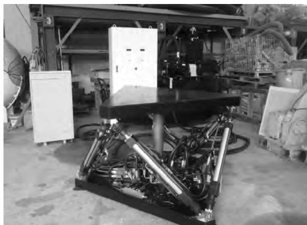
写真-1 モーションベースプロトタイプ（左端より制御装置、モーションベース、油圧ユニット）
