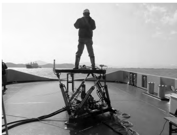
写真-8 動揺低減効果体感試験
